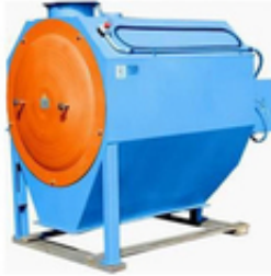
Основные технические характеристики - барабанный скальператор А1-Б32-О.
